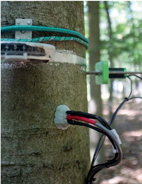
*Abb. 10: Twittert diese Buche? Ein Experiment des Thünen-Instituts in Britz. »TreeWatch« ist ein sechs Standorte in Deutschland, Belgien, Großbritannien und den Niederlanden verbindendes Werkzeug, das die hydraulische Funktion und das Wachstum von Bäumen in Echtzeit demonstriert.*
